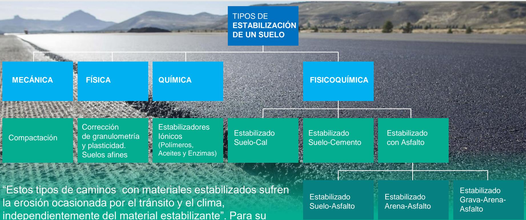
“Estos tipos de caminos con materiales estabilizados sufren la erosión ocasionada por el tránsito y el clima, independientemente del material estabilizante”. Para su protección se debe recurrir a riegos y revestimientos.
